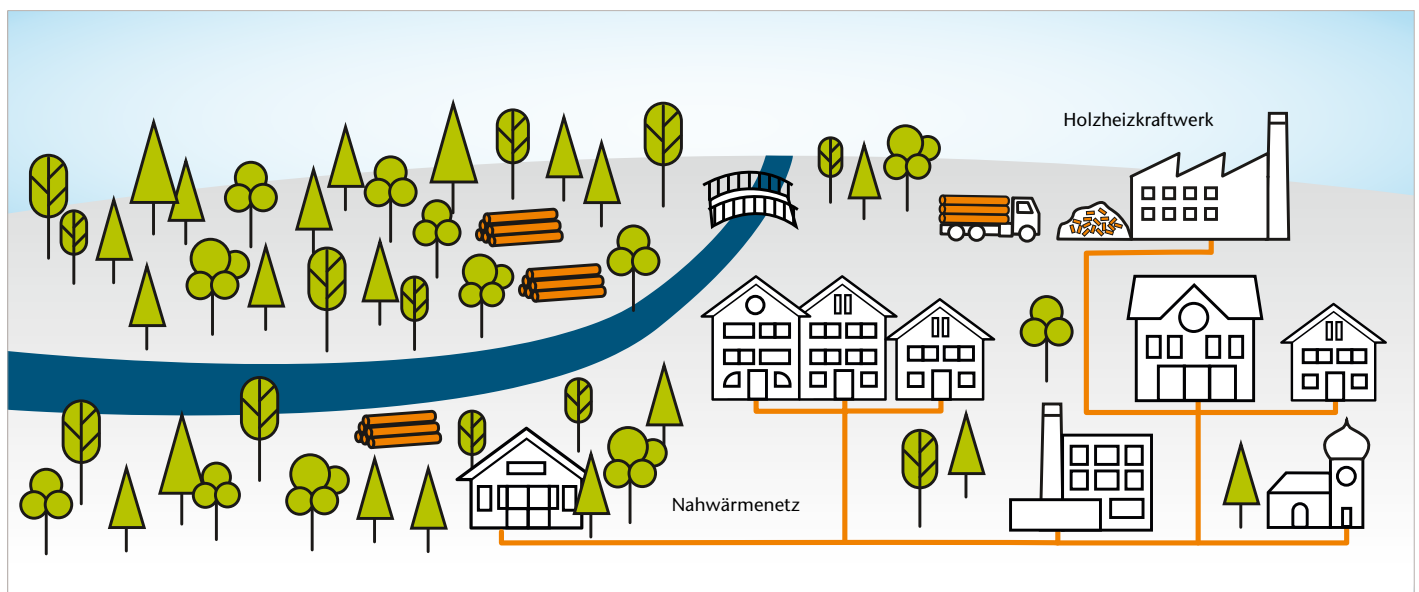
Beispielhafte Darstellung einer Hackschnitzel-Wärmeversorgung
