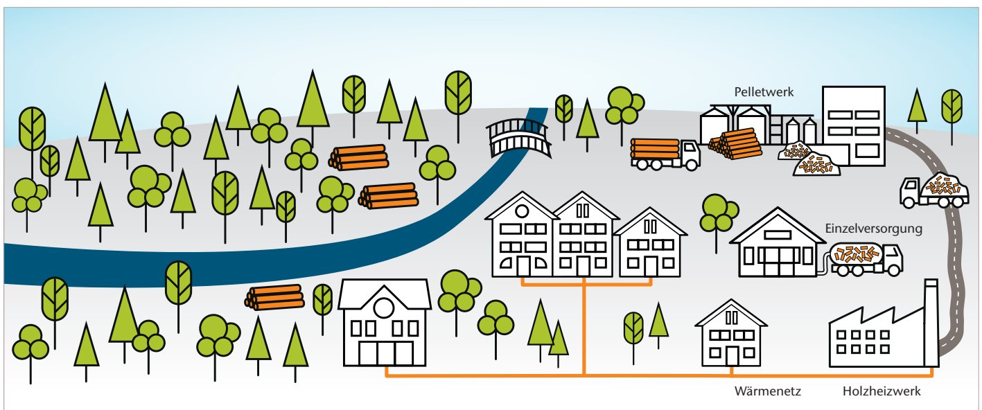
Beispielhafte Darstellung einer Wärmeversorgung mit Pellets
