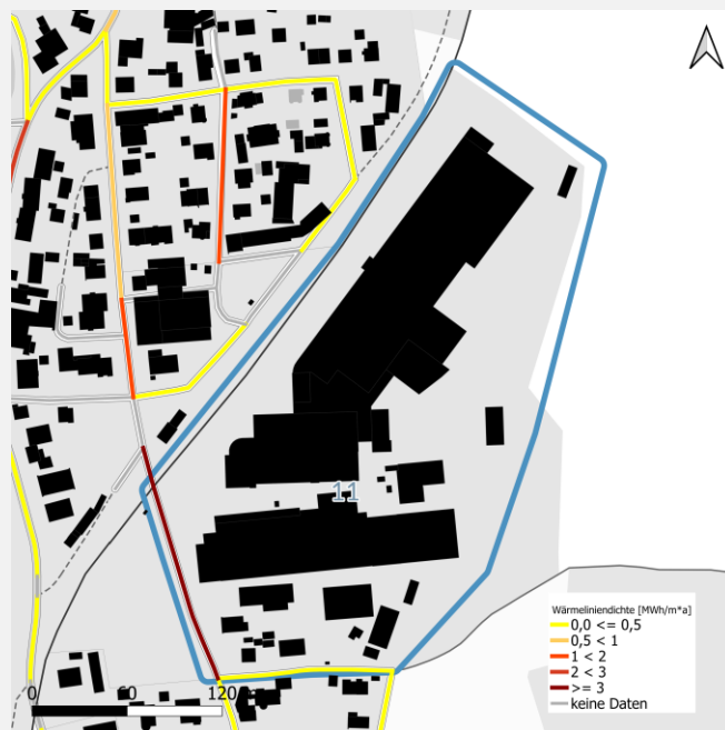
Wärmeliniedichte (Indikator für Wärmenetz)
