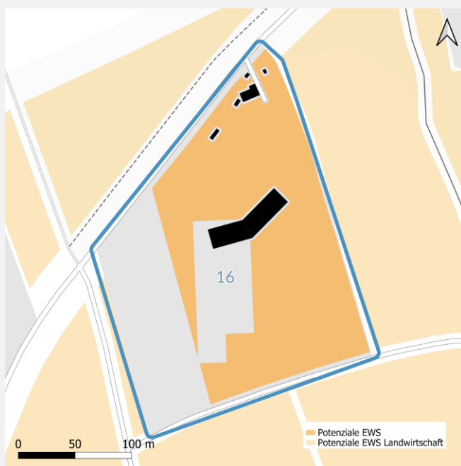
Nutzung von oberflächennaher Geothermie durch Erdwärmesonden
